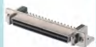
6311系列 SCSI DB型 锌合金 母头 90度 连接器 Spec:SCSI DB-Type Right Angle Female Connector Positions:50/68/100P
